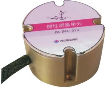
PA-IMU-01D惯性测量单元是一款高性能、低价位的惯性测量设备，可用于导航、控制和动态测量。此系列产品采用密封设计，在恶劣环境下仍能精密的测量运动载体的角速度和加速度信息。
