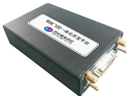
该系统为了合理整合惯导\飞控系统的各种硬件资源，优化惯导\飞控系统总体设计工作，降低产品成本、体积和重量，提高制导/控制系统的可靠性，我对飞行器惯导\飞控系统进行了一体化、集成化和模块化的设计。
